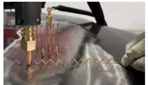
Conçu pour effectuer diverses opérations de carrosserie telles que l'arrachage de dents, le soudage de tampons à mésons ronds, les mésons OT, le fil ondulé, les goujons ; soudage par points à jet direct ; lissage et élimination des bosses et des bosses. Equipé d'un système de protection automatique contre la surchauffe, il génère un petit point en 2 secondes, réduisant le degré de carbonatation et améliorant l'efficacité du travail.
