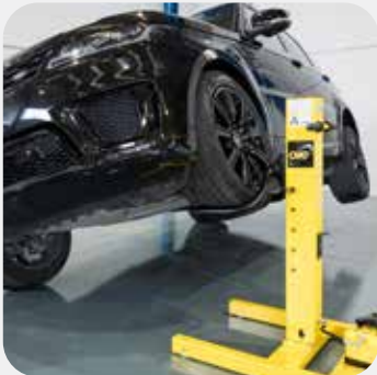
levage sur la roue avant
