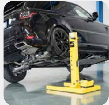
levage de roue arrière
