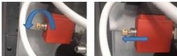
3. Appuyez sur le bouton bleu d'alimentation en air et, pendant ce temps, appuyez sur le noyau rouge de la valve et tournez-le dans le sens inverse des aiguilles d'une montre jusqu'à ce que vous entendiez un son indiquant que la valve est ouverte. À ce stade, les plates-formes de levage peuvent être abaissées.
