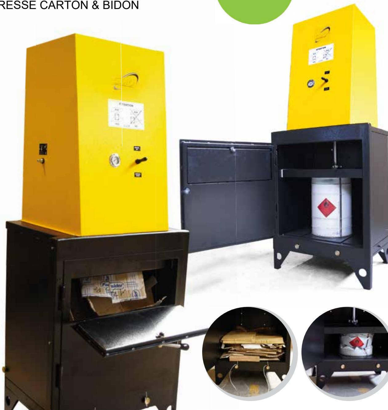
Bulldozer est une presse robuste et polyvalente, fabriquée en Italie, pour compresser cartons et bidons de peinture. Elle supporte des contenants jusqu'à 6,6 gallons et fonctionne à 116 psi avec un système d'air comprimé (8 bars). Équipée de portes doubles pour une utilisation facile, elle comprend des manomètres de contrôle pour une compression précise et efficace.
