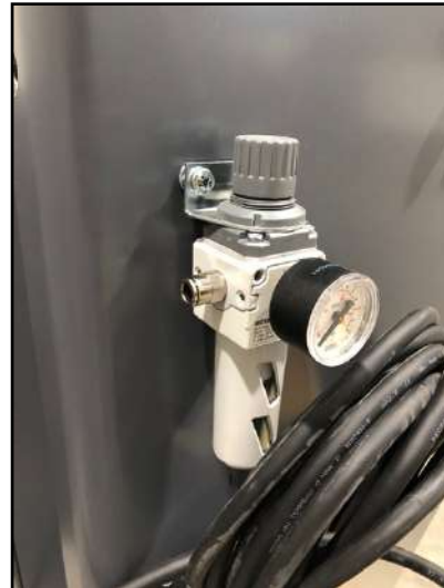
Fig.9 Filtro con manometro
